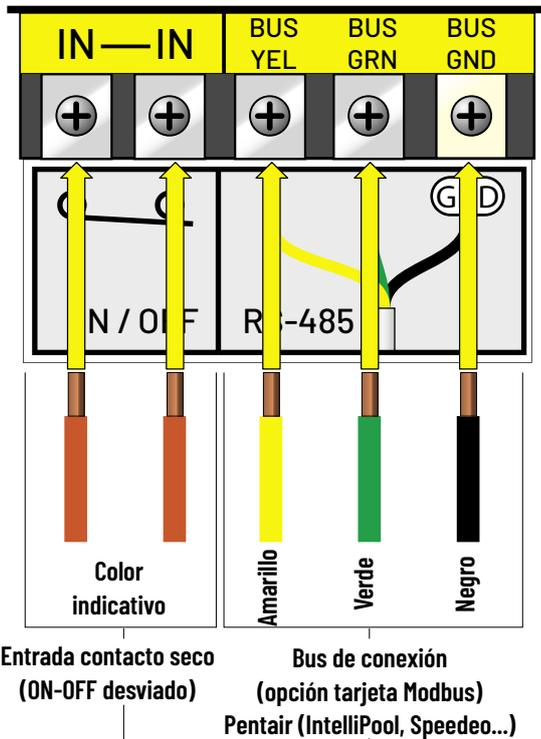
Entrada contacto seco (ON-OFF desviado), retirar el shunt existente
