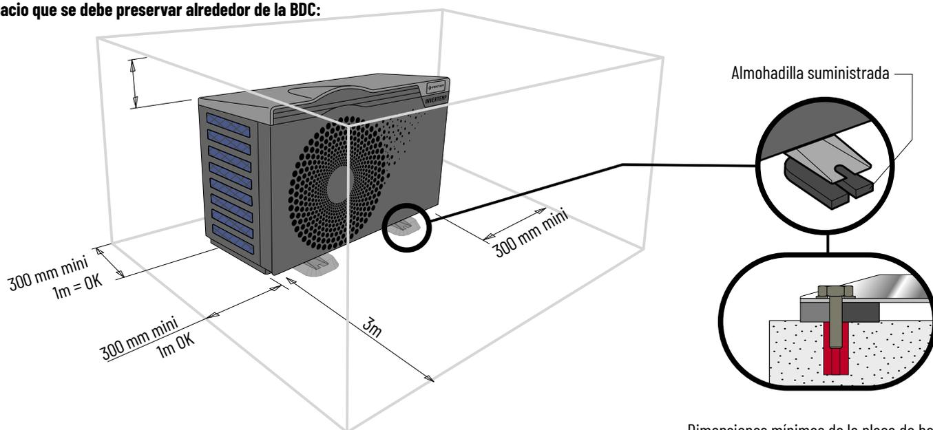
La BDC debe instalarse permanentemente sobre una placa rígida y fija colocando las almohadillas suministradas bajo las patas.
