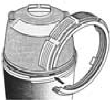
Figure 5 - Insérer les pattes dans les ouvertures dans le corps du filtre.
